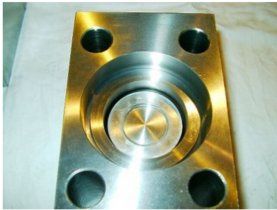
ブレーカーリングを挿入
